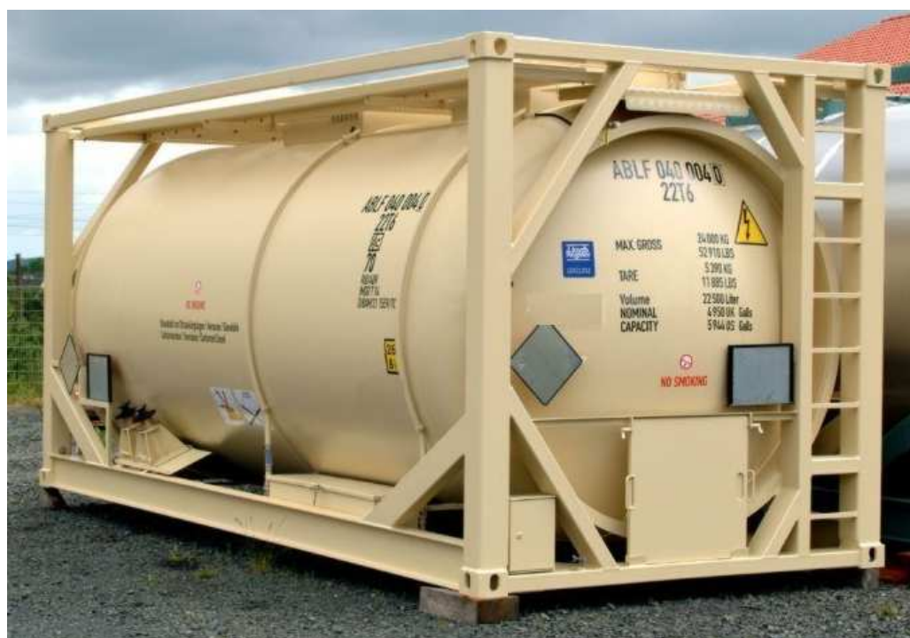
Kontejner na pitnou vodu – kapacita 16 – 22 m3
