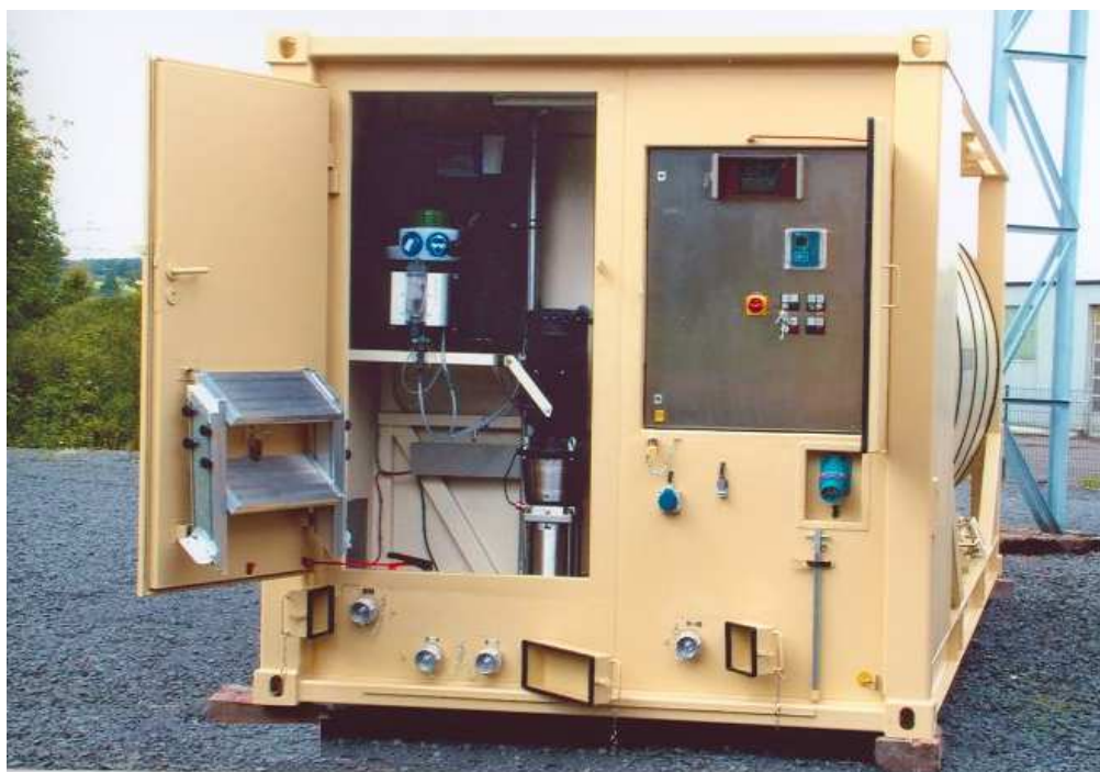
Kontejner na pitnou vodu – kapacita 16 – 22 m3
