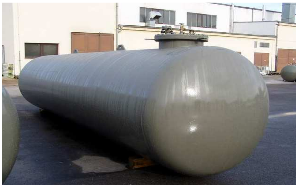
ukázka podzemního zásobníku kapalin
